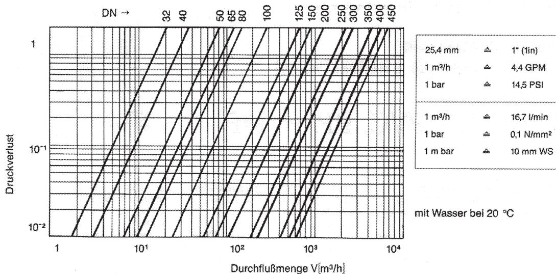
Die Werte resultieren aus den Messungen an Klappen bei Einbau in waagrechter Leitung. Um Druckverluste bei anderen Medien zu ermitteln, ist zuvor die gleichwertige Wasserdurchflussmenge zu berechnen.
